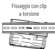
Fissaggio con clip a torsione
