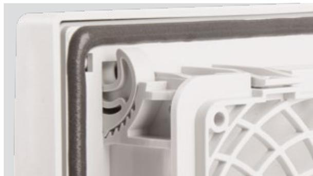
Il ventilatore con filtro Plus è installabile dall'esterno del quadro senza l'utilizzo di attrezzi grazie al suo pratico dispositivo di bloccaggio rapido costituito da ganci a cricchetto integrati. Oltre alla sua semplicità, questo sistema ha il vantaggio di dare un immediato feedback acustico all'installatore, che udirà uno scatto non appena il dispositivo sarà installato in sicurezza. Questo sistema è adatto per pareti con spessore da 1 a 4 mm.
