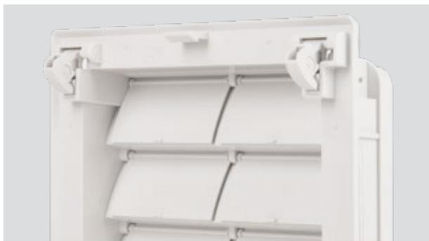
La nuova tecnologia air-flap elimina la necessità del filtro per l'aria in uscita, aumentando considerevolmente il flusso d'aria. In questo modo il raffreddamento del quadro risulta molto più efficace. Un altro vantaggio: se il ventilatore non è in uso i flap rimangono abbassati impedendo alla polvere di entrare nell'armadio.
